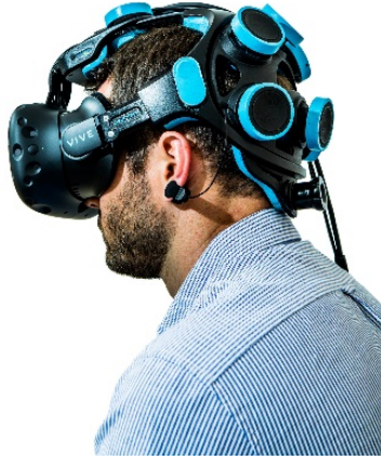
Figura 8.6: Prototipo de Neurable para implementar un sistema BCI en conjunto con lentes de realidad virtual.
