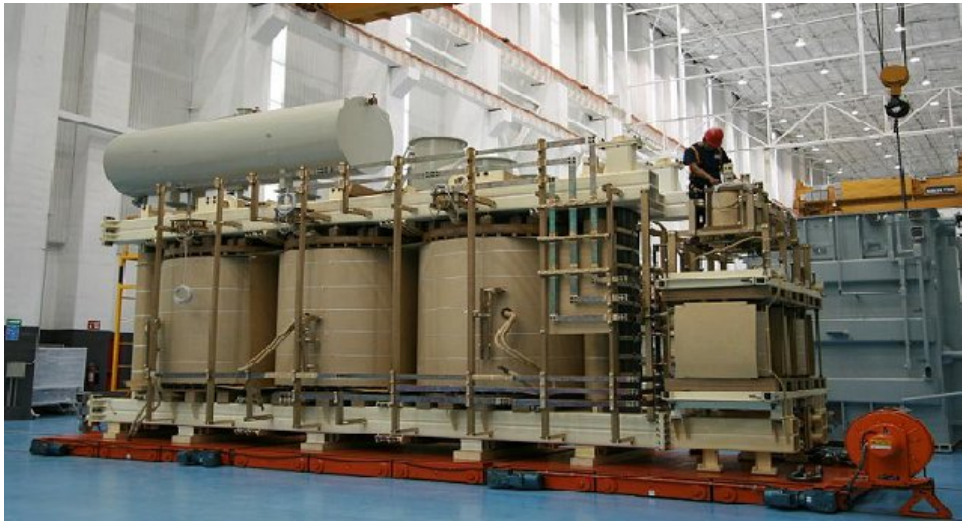
Figura 6.1: Parte interna de un transformador. Se muestra el ensamblado del núcleo y los devanados. (Cortesía de Prolec GE ®).
