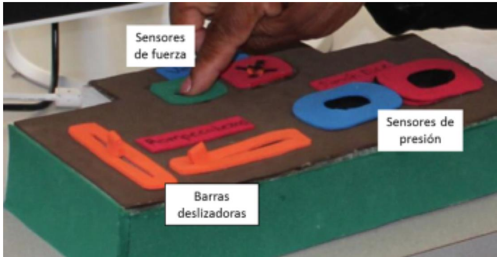
Figura 8-2. Control personalizado con sensores de presión, tacto y deslizamiento.
