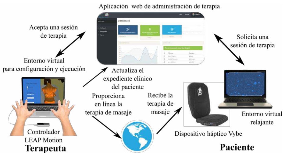
Figura 8-5. Arquitectura del sistema GoodVybesConnect.
